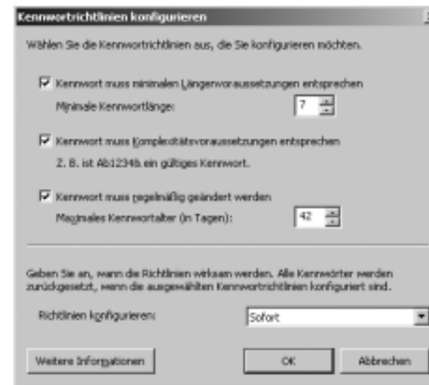
Abbildung 9: Über Kennwortrichtlinien kann ein Administrator einstellen, welche Beschaffenheit die Kennwörter von Benutzern aufweisen und wie häufig Benutzer ihre Kennwörter ändern müssen.
